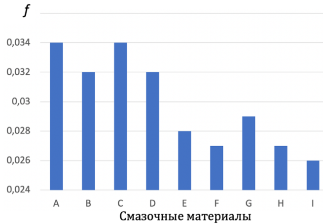
Рисунок 13 – Среднее значение коэффициента трения при исследуемом масле с добавками: А – без смазочного материала, В – масло, С – масло + 0,1 % C_{60} , D – масло + 0,2 % C_{60} , E – масло + 1 % C_{60} , F – масло + 2% C_{60} , G – масло + 0,1 % УНТ, H – масло + 0,2 % УНТ, I – масло + 1 % УНТ
